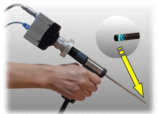
HiSpec1 とボアスコープによる撮影 (上部は、側視用のミラーチューブ)
